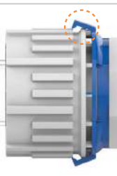
너트 체결 상태 불량 (과체결 상태)
