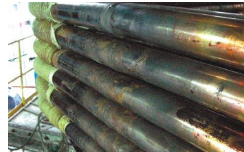
구리 관 용접 (ID 48Ø, OD 72Ø) Cu pipe welding
