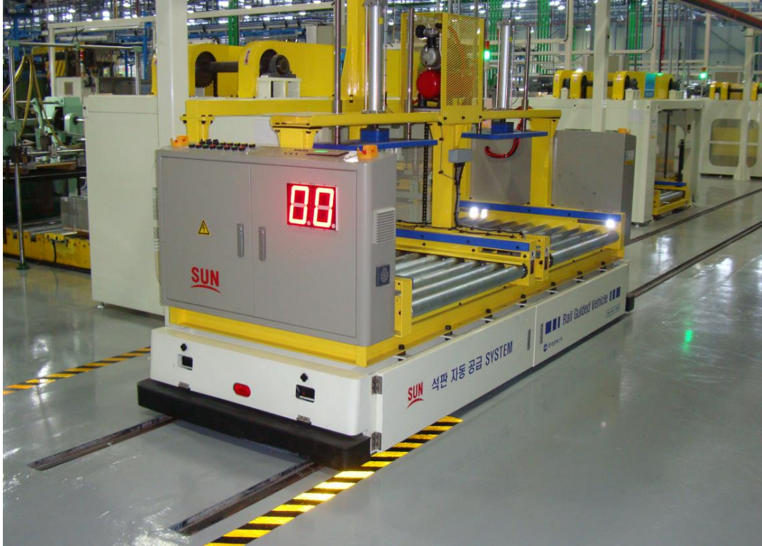
In-Out Let Lifter(3 ton) – 승,하강 Motor 구동방식(다단속)
