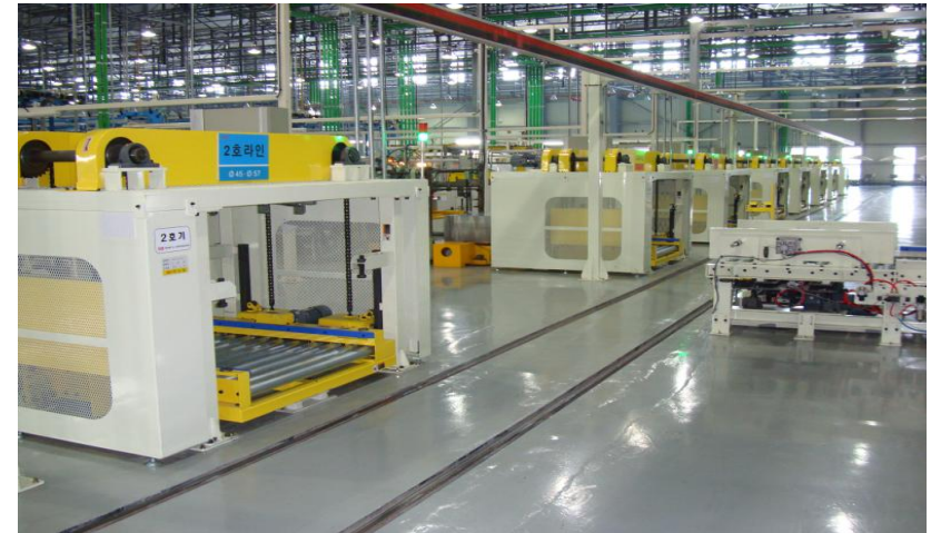
In-Out Let Lifter(3 ton) – 승,하강 Motor 구동방식(다단속)
