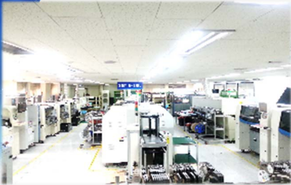
▲ SMT 라인: Surface Mounter Technology SMD 자재 실장 라인
