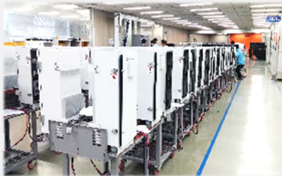
▲ 절연 저항/내력 시험 라인: 절연 저항 / 절연 내력 시험
