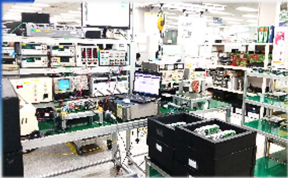
▲ 특성 시험 및 내전압 평가 라인: 전기적 특성 및 내전압 시험
