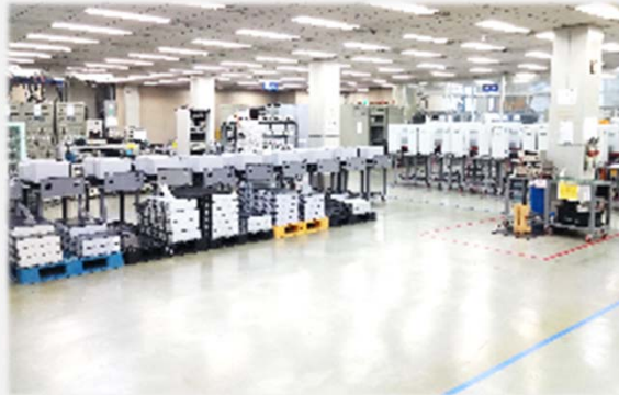
▲ ASSY II 라인: 랙형 전원장치 조립 라인
