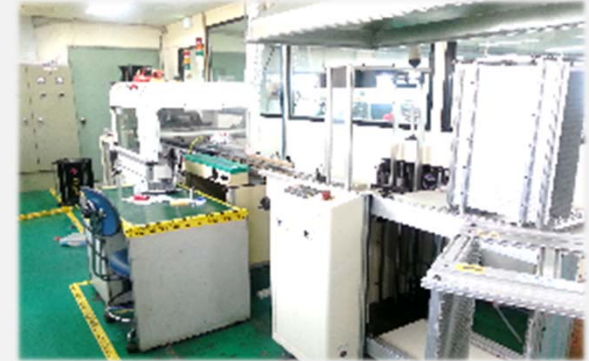
▲ PCB 코팅 라인: 부식 방지를 위한 PCB 코팅 라인
