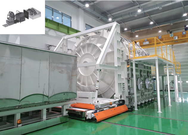
극한환경 지반 대형 열진공 챔버 - 우주환경 모사장치 Extreme environment ground large thermal vacuum chamber - Space environment simulator.
