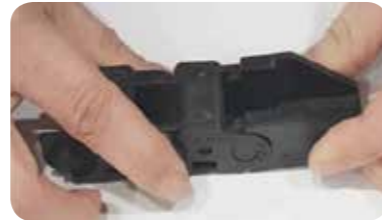
6 고정 혹은 무빙브라켓의 좌, 우 한곳을 20° 비틀어서 조립한다. Assemble one of the left and right sides of a fixed or moving bracket by twisting it by 20°.
