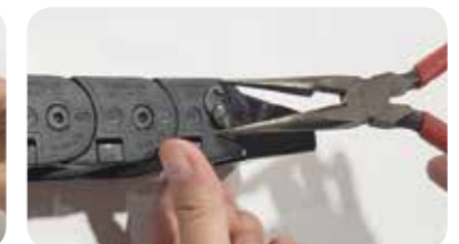
3 바디무빙단에 롱노즈를 사용해 E링을 체결한다. Assemble the E-ring using long nose plier on the body moving side.
