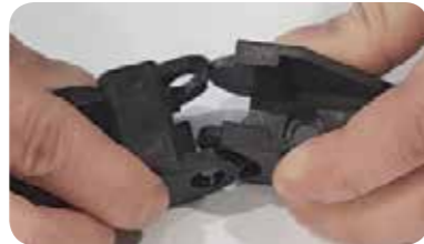
5 바디링크와 고정 혹은 무빙브라켓을 준비한다. Prepare body links and fixed or moving brackets.
