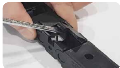
1 커버 해체시 바디 힌지부에 "—" 드라이버를 이용해 외측커버를 빼낸다. Use a flat-head screwdriver to remove the outer cover from the body hinge when removing the cover.
