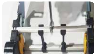
11 상측 BAR 해체시 12mm 스패너를 이용 90° 회전시켜 상측 BAR를 해체한다. When disassembling the outer BAR, use the 12mm spanner to rotate the upper BAR by 90°.
