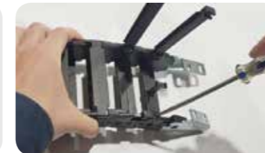
2 링크 해체시 "—" 드라이버를 링크연결부 사이에 넣어 바깥쪽으로 틀어서 해체한다. When disassembly a link, put a flat-head screwdriver between the link connections and turn it outward to disassemble it.
