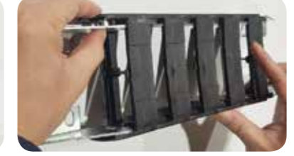
6 무빙브라켓을 바디 홈부에 무빙브라켓 돌출부와 결합한다. Assemble the moving bracket with the moving bracket on the body hole.
