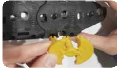
2 연결된 바디에 링크핀을 체결한다. Assemble the link pin on the connected body.
