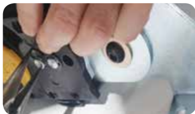
10 무빙브라켓과 플레이트를 엔드 링크핀과 E링으로 함께 체결한다. Tighten the moving bracket and plate together with the End link pin and E-ring.
