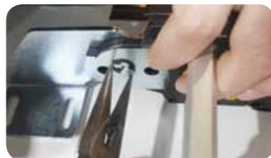
8 고정브라켓과 플레이트를 엔드 링크핀과 E링으로 함께 체결한다. Tighten the fixing bracket and plate together with the End link pin and E-ring.
