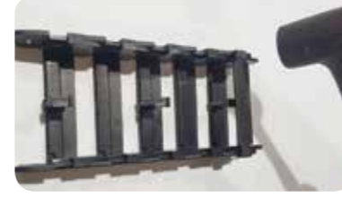
4 디바이더를 체결 후 외측커버를 조립한다. After assembling the divider, assemble the outer cover.
