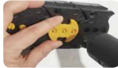
3 바디뒷면에 링크핀 커버를 링크핀과 조립한다. Assemble the link pin cover with the link pin on the back side of the body.
