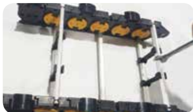
7 디바이더 체결후 상측 오픈 BAR를 스패너를이용 회전 체결한다. After inserting the divider, rotate the upper outer BAR using a spanner.
