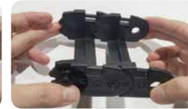
2 바디링크 좌, 우 한곳을 20° 비틀어서 조립한다. Twist one body link left and right by 20° to assemble.
