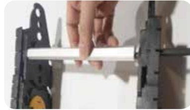
5 좌, 우 바디를 하측 BAR를 이용 연결하고 렌치볼트로 체결한다. Tighten the left and right body using the BAR and wrench bolts.
