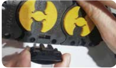
4 바디전면에 NP CAP을 고무망치를 이용해 체결한다. Insert the NP CAP on the front of the body with a rubber hammer.
