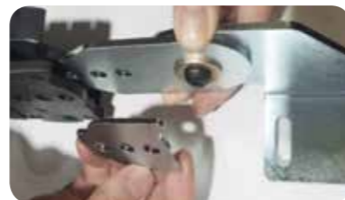
9 무빙브라켓과 무빙 플레이트를 바디홈에 끼운다. Insert the moving bracket and the moving plate into the body groove.
