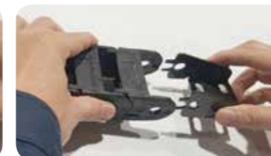
2 무빙브라켓을 바디 홈부에 무빙브라켓과 체결한다. Assemble the moving bracket with the moving bracket on the body hole.
