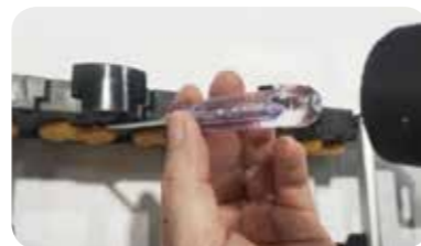
12 바디 해체시 링크핀을 "-" 드라이버를 링크핀 커버 홈에 넣어 망치를 이용해 해체한다. When the body is disassembled, insert the flat-head driver into the link pin cover groove and use a hammer to disassemble it.
