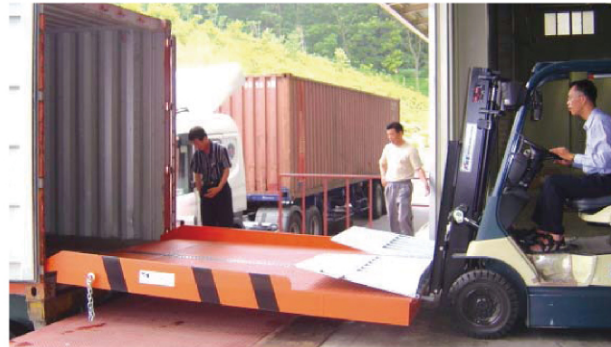
지게차에 의한 분리 결합 (Separation & Connection By A-Forklift)
