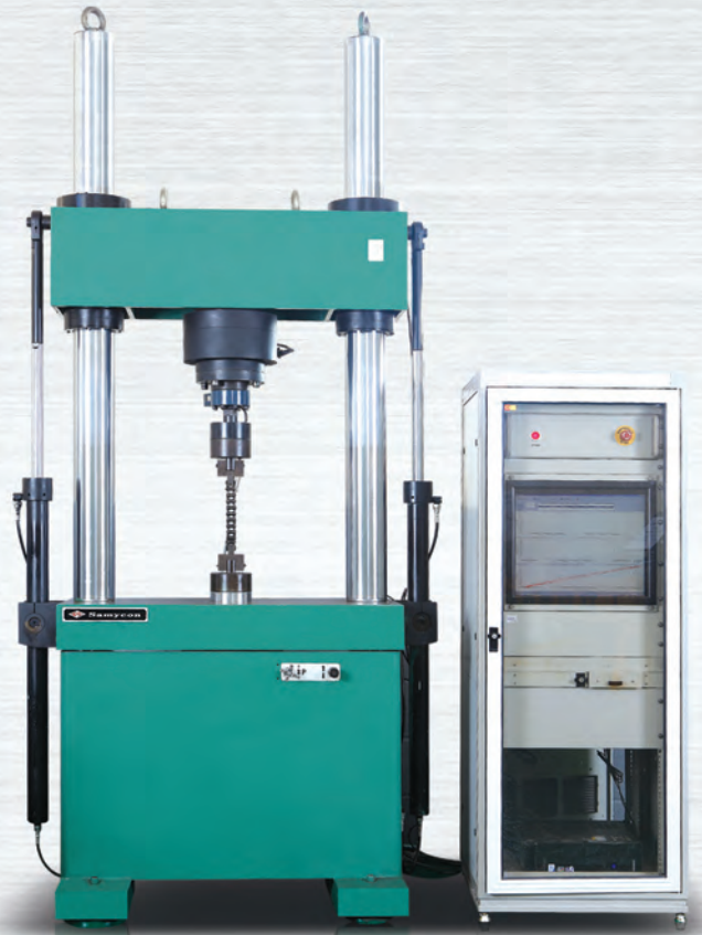
한국체인공업(주) 시험실내 피로시험기 Fatigue test equipment
