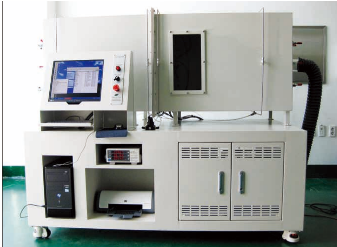
FAN TESTER 풍량 / 흡입 : 0 ~ 500CMH, 정압 : 0 ~ 최대 500Pa
