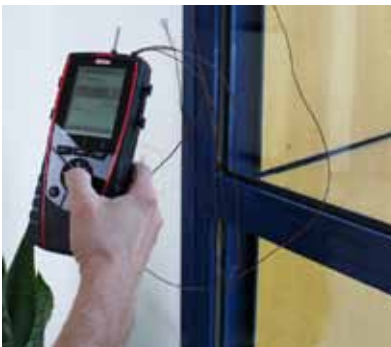
열관류율 모듈을 이용하여 창호 단열성능 측정
