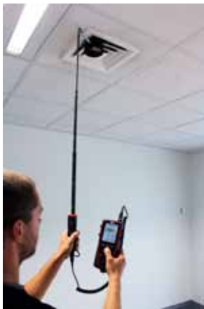
텔레스코픽 베인 프로브를 통한 풍속, 풍량 측정
