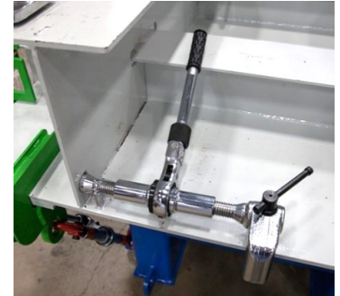
T-Bar 용접라인 맞춤 작업
