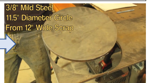
홀 커팅 작업 완료
