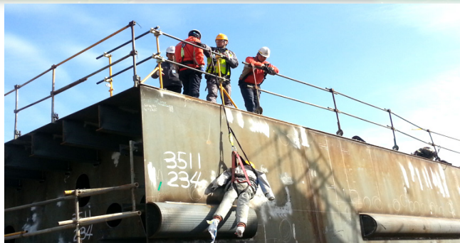
조선소 현장 테스트 (마네킹 무게 70kg)
