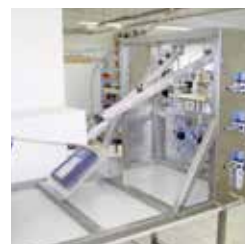
(왼 쪽) 4930 RF 쉴드의 메커니컬 라이프 테스트 (오른쪽) 4930 RF 쉴드: EMC 실험실에서 송신 안테나와 함께 측정
