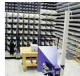
(왼 쪽) 4930 RF 쉴드의 메커니컬 라이프 테스트 (오른쪽) 4930 RF 쉴드: EMC 실험실에서 송신 안테나와 함께 측정
