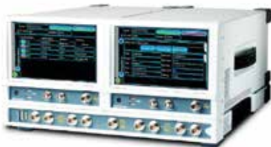
SCO 컴바이너로 두 대를 한 시스템으로 합친 모습
