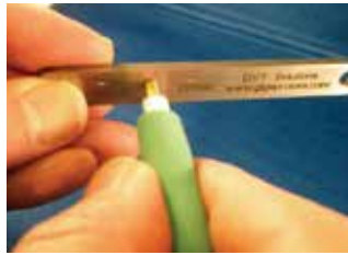
그림 3. Signal-Signal Pitch Calibration: Model 10 SMA 교정 렌치로 빈번히 사용하는 0.8 mm, 1.0 mm, 1.27 mm 간격을 조정. 프로빙 위치 를 조정하고 이외의 다양한 간격을 정밀하게 조정하기 위해서는 기본 포함된 트위저와 탁상용 확대경 사용
