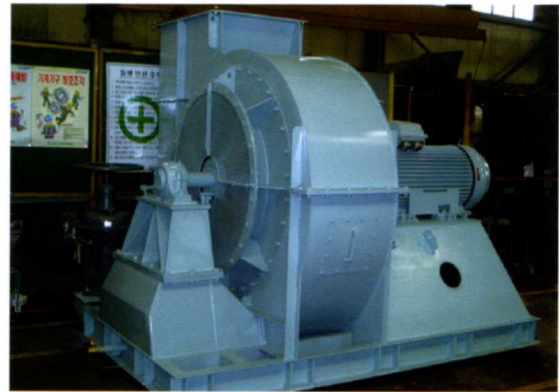
▲ Main Boiler F.D Fan
