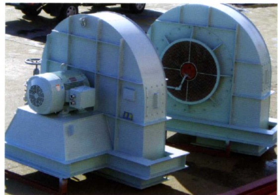
▲ Aux. Boiler F.D Fan
