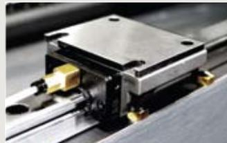
응답성이 우수한 LM Guide 적용으로 이송시 발생 하는 소음을 최소화하였으며 이송속도가 우수하여 비절삭 시간을 단축 하였습니다.
