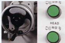
13. 상하급이송장치 Rapid up down feed equipment (YGS-52A 이상 적용, 상향/중 제외)
