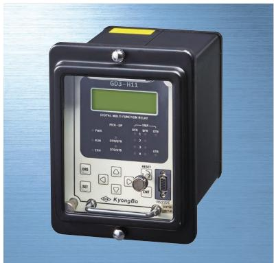
본 계전기는 한전 디지털 저주파수 계전기 일반 구매 규격에 따라 설계 제작되었으며, 송 전선로 보호, 분산전원 연계선로 등에서 과주파수, 저주파수 등에 대한 보호에 적합하게 설계된 Digital 계전기로서 4단계까지 정정하도록 되어 있으며, 선로 재폐로 등으로 인한 주파수 오동작을 방지하기 위해 오동작 방지용 UVR 요소가 내장되어 있어 계전기의 신뢰성을 확보하였습니다. 또한 계전기 Signal용 출력접점이 2a, 2b로 되어 있어 Panel 구성 시 별도의 보조 Relay를 사용할 필요가 없으며, 또한 계측기능, Event 및 고장파형 기록기능, 자기진단 기능, SCADA 연계 통신기능도 갖추어져 있어 사고분석과 설정 변경, 자료 취득 등이 쉽도록 HMI 프로그램을 함께 제공합니다.
