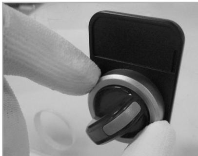
(1) 명판링 반시계 방향으로 회전하여 명판링 제거 (Disassemble the name plate ring to turn it counterclockwise)
