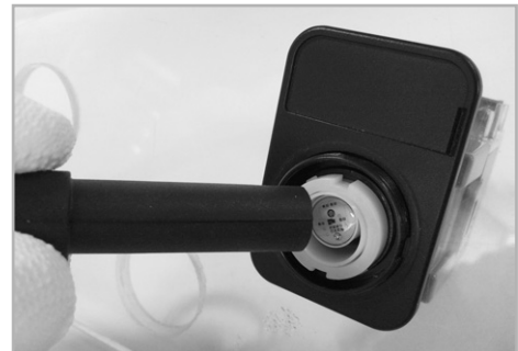
(3) LED 공구를 누른 후 반시계 방향으로 회전시켜 LED 램프 분리 (Remove the LED lamp to press the LED tool and turn it counterclockwise)
