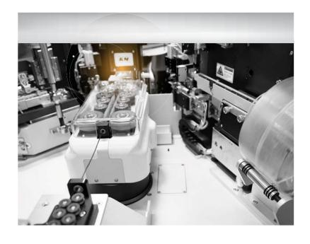
양단압착 4,000개 이상의 생산력과 양단 씰 삽입장치, 더블압착, 솔더링장치. 중간탈피, 오토하이트, 디지털 프레스 및 펴주기 장치 등 다양한 옵션 장치와의 연동성 등 P1의 프로미업금 성능에 벨트피딩방식을 더했습니다. 특수 우레탄 벨트의 높은 마찰력과 실시간 엔코더 보정기능으로 5sq 전선도 길이 편차 없이완벽하게 작업 가능한 P1B 모델은 나날이 까다로워지는 작업사양에 가장 이상적인 모델로 귀사의 작업현장에서 빛을 발할 것입니다
