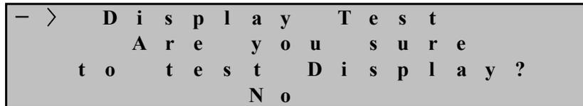
Display Test를 하기 위해서는 이 화면에서 Key를 눌러 “No”를 “Yes”로 바꾼 다음 ENTER ( ) Key를 누르면 LCD에 TEST문자가 3회 깜박이며 동시에 모든 LED가 3회 점멸한 후 Test 메뉴로 이동합니다.
