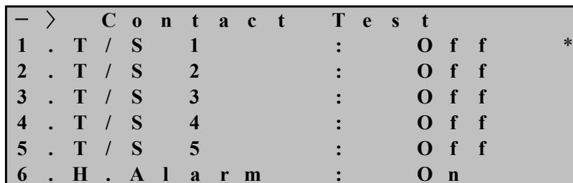
T/S1 ~ T/S5 접점을 Test하려면 원하는 접점을 선택한 후, Key를 눌러 On으로 바꾼 다음 ENTER ( ) Key를 누르면 접점이 활성화 후 “딸깍”하는 소리와 함께 Off로 복귀합니다.
