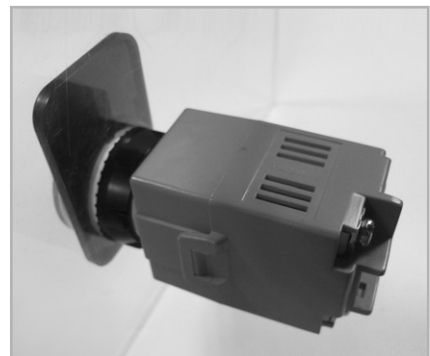
(3) 트랜스부를 홀다부에 밀어 끼운다 (Push the trans part into the holder part)
