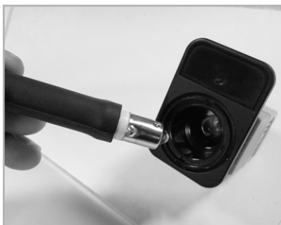
(1) 전면캡 반시계 방향으로 회전하여 캡을 제거 (Remove the CAP to turn counterclockwise)
