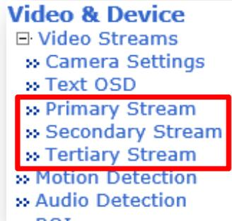
트리플 스트림의 이점은 IP 카메라부터 세 개의 스트림을 지원해 줍니다. Primary stream 은 FHD 이상의 해상도로 영상 녹화를 함과 동시에 Secondary stream 을 이용하여 저 해상도로 실시간 감시 혹은 모바일 에서 보는 것을 지원해 줄 수 있습니다. 이 기능으로 NVR 서버나 혹은 고객들이 다수에 카메라를 볼 수 있으며 낮은 대역폭과 적은 CPU 사용을 가능하게 해줍니다.
