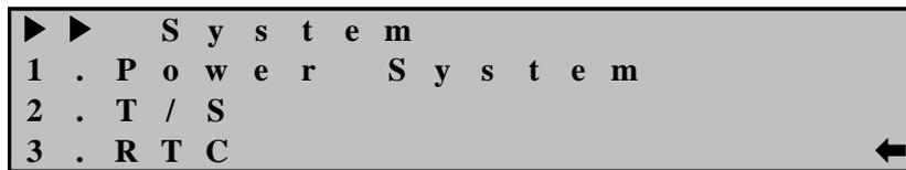
(4) 우(→)방향 Key 누름 : Setting ▶ System ▶ RTC 화면 표시
