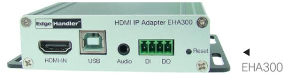
**EHA300(엣지핸들러 네트워크 어댑터 EHA300)** 은 HDMI 출력 장치, PC, DVR, NVR, I/O 장치 등 대상 장치에 연결되는 네트워크 어댑터입니다. HDMI 비디오 신호를 압축, 인코딩 하고 마우스와 키보드, 제어 정보를 네트워크를 통하여 전송하며 파일 송수신 기능을 제공합니다. 또한 어댑터에 연결된 시스템에 별도의 소프트웨어를 설치하지 않습니다. 엣지핸들러 디코더(EHD200)를 이용하여 원격 비디오 장치를 제어할 수 있습니다.
