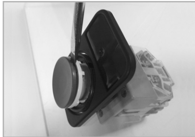
(2) 캡 측면 홀부에 (-)드라이버로 삽입하여 캡 분리 (Disassemble the cap at side of the cap over with (-) type driver)
