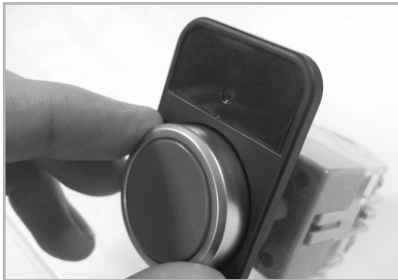
(1) 명판링 왼쪽으로 돌려 분리 (Disassemble the name plate ring from original position to turn it left)
