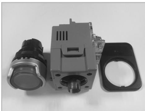
(1) 트랜스부 레바를 밀어 홀다부 분리한다 (Separate the holder part to push trans part)
