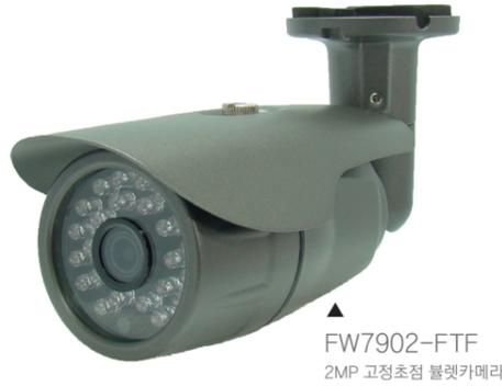
**FW7902-FTF** 은 고품질 볼렛타입 IP카메라로 2.13MP(유효화소) 프로그레시브 스캔 CMOS 이미지센서를 탑재했습니다. 최고 감도를 자랑하는 소니 스타비스 센서가 탑재돼 저조도 조건에서 특히 우수합니다. H.265, H.264, MJPEG 비디오 압축을 동시에 지원하므로 낮은 네트워크 대역폭과 작은 용량의 영상녹화가 가능합니다. 프로그레시브 모드에서 최대 30fps@2MP (1920X1080) 지원으로 고화질의 깨끗한 영상을 전달합니다.
