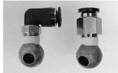
【写真1】目玉ノズルにタップ加工をして、フィッティングを取りつけます。
