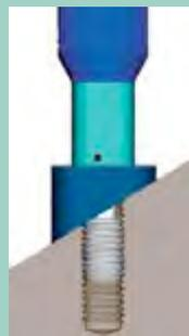
Schräge Anlageflächenhülse für schräge Bohrungen.
