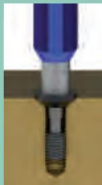
Kegelige Anlagefläche für spezielle Bohrungsansätze.
