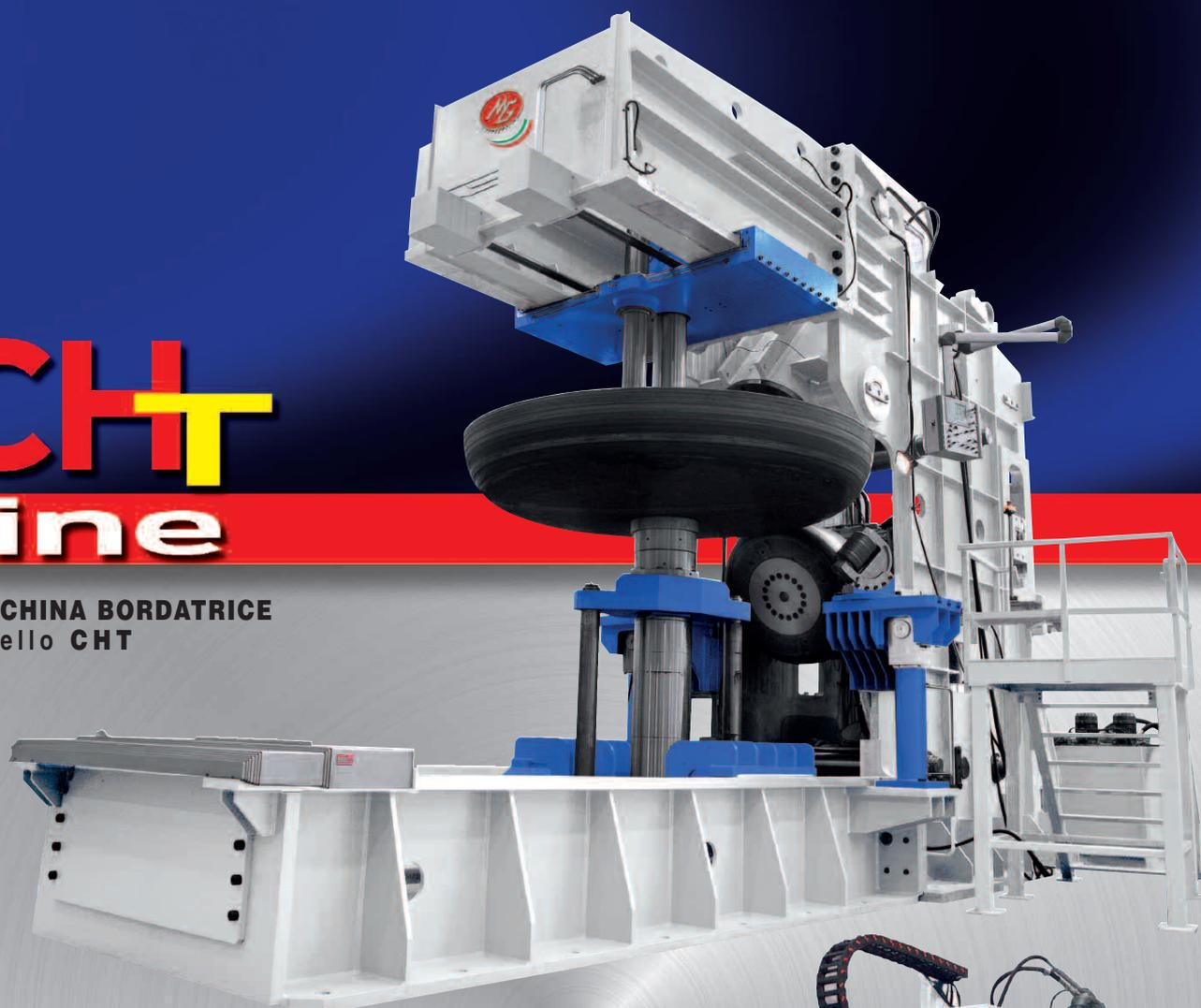
Per la produzione dei bordi nei fondi piani o bombati con o senza foro centrale. Completamente idraulica con rulli formatori di diverso raggio del bordo. I comandi sono ridotti al minimo in un pannello di controllo mobile per un facile utilizzo da parte dell'operatore.
