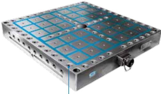
Piano magnetico realizzato con bussole ed helicoils
