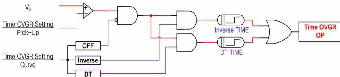
**【Figure 3.2】 TIME OVGR(TOVGR) Logic Diagram**
