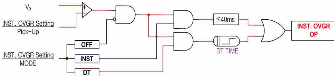
**【Figure 3.1】 INST. OVGR(IOVGR) Logic Diagram**
