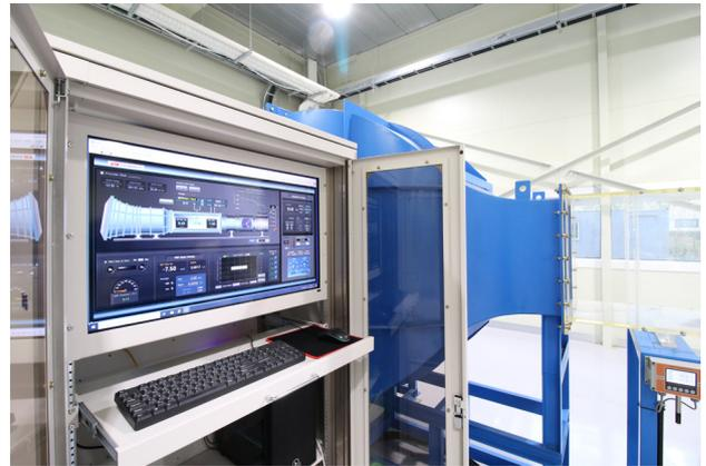
Picture 2,3 - KMSG-8000MI/TMS 실 유속 및 방향 민감도 테스트 프로그램
