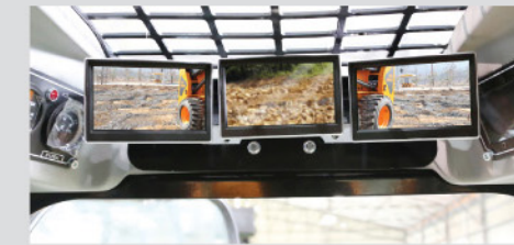
후방카메라 (옵션) 사이드미러만으로 운전시 후방의 안전이 확보되지 못했던 작업환경을 더욱 안전하게 하는 후방카메라를 장착
