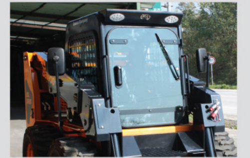
일체형 캐빈 (옵션) 전방 출입문으로 와이퍼를 장착, 좌우 개폐형 창문, 전방 후방 윈도우 장착. 에어컨과 히터의 사용성이 향상된다.
