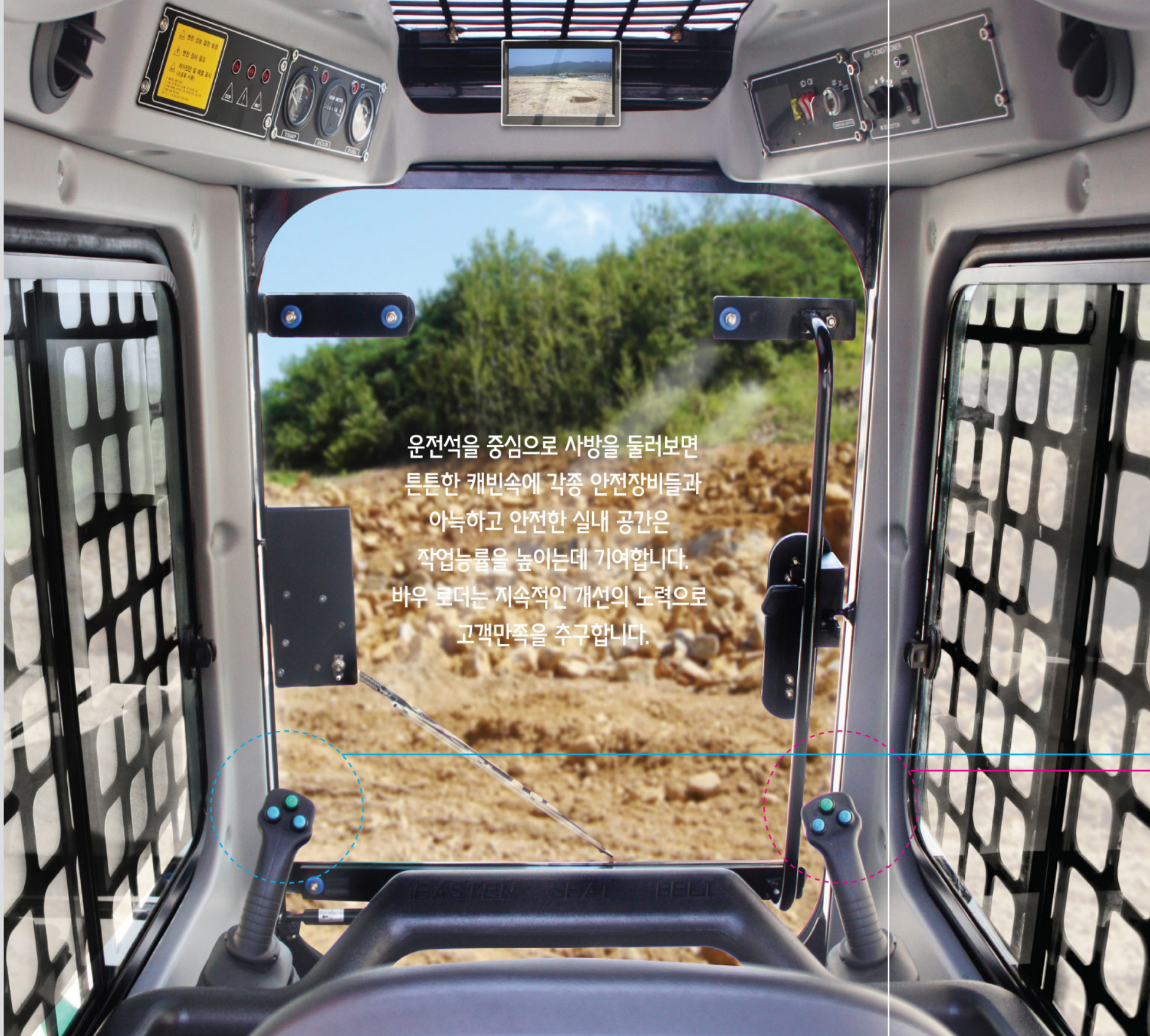
후방카메라 (옵션) 사이드미러만으로 운전시 후방의 안전이 확보되지 못했던 작업환경을 더욱 안전하게 하는 후방카메라를 장착
