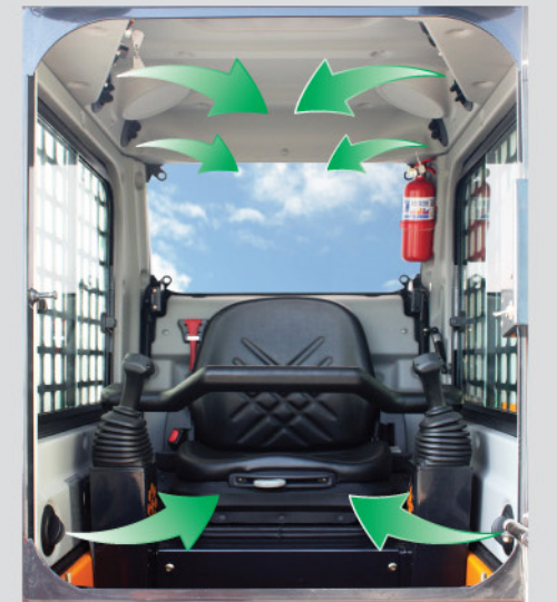
일체형 에어컨과 히터 (옵션) 뜨거운 날씨가 추운 겨울에 쾌적한 작업환경을 유지하여 작업능률에 효과가 큰 옵션 기능.
