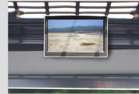
후방카메라 (옵션) 사이드미러만으로 운전시 후방의 안전이 확보되지 못했던 작업환경을 더욱 안전하게 하는 후방카메라를 장착
