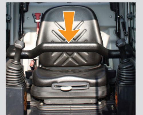
안전바 안전바를 내려야만 기본 작동을 할 수 있게하여 운전자의 운전 및 작업 시 위험을 최소화 합니다.
