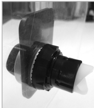
(2) 홀다부 체결링을 분리하고 명판을 끼운 후 패널에 조립한다 (Disassemble the connecting ring and then assemble it into the panel)
