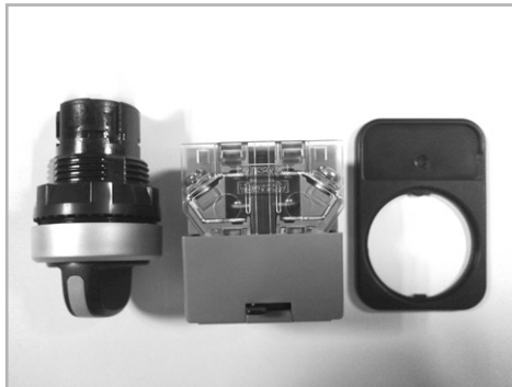
(1) 접점부 레바를 밀어 홀다부 분리한다 (Push the contact part, and then separate the holder part from contact part)
