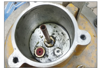
<수명 연장> 1. 소모성 패킹과 내부 부품 교체가 쉬어짐. 2. 공기량 오차와 게이지 고장을 유발하는 공기실 내부의 물과 분진을 청소할 수 있음.
