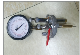
니들밸브와 볼트3개 분리로 공기실을 열기 쉬운 구조로 설계 되었음. 사용자도 직접 유지보수가 가능.
