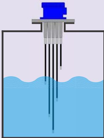
탱크 내부 수위가 높아지게 되면 수위 센서에 설정된 Control Start 지점에서 DEC-5U-2WN의 START 램프(Lamp)가 점등 되면서 Control 접점 신호가 연결된 밸브(Vavle), 펌프(Pump), 경보(Alarm) 등을 구동 합니다.
