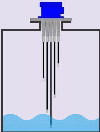
탱크 내부 수위가 낮아지게 되면 수위 센서에 설정된 Control Start 지점에서 DEC-5U-2WN의 START 램프(Lamp)가 점등 되면서 Control 접점 신호가 연결된 밸브(Valve), 펌프(Pump), 경보(Alarm) 등을 구동 합니다.
