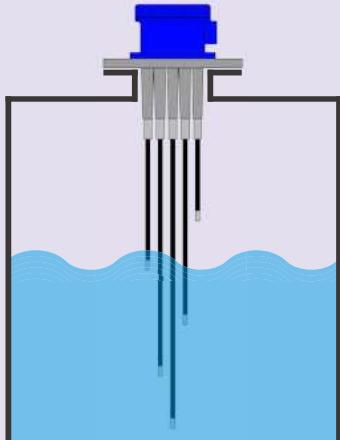
탱크 내부 수위가 높아지게 되면 수위 센서에 설정된 Control Stop 지점에서 DEC-5U-2WN의 STOP 램프(Lamp)가 점등 되고 START 램프가 점멸 되면서 Control 접점신호가 연결된 밸브(Valve), 펌프(Pump), 경보(Alarm) 등을 정지.
