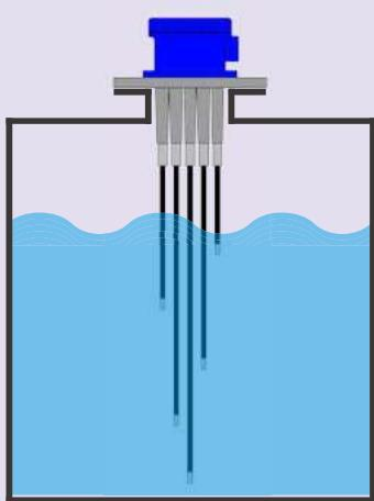
탱크 내부 수위가 높아지게 되면 수위 센서에 설정된 High 지점에서 DEC-5U-2WN의 High 램프(Lamp)가 점등 되면서 High 접점신호가 연결된 밸브(Vavle), 펌프(Pump), 경보(Alarm) 등을 구동하게 됩니다.
