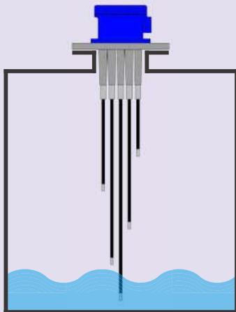
탱크 내부 수위가 낮아지게 되면 수위 센서에 설정된 Control Stop 지점에서 DEC-5U-2WN의 STOP 램프(Lamp)가 점등 되고 START 램프가 점멸 되면서 Control 접점신호가 연결된 밸브(Vavle), 펌프(Pump), 경보(Alarm) 등을 정지.
