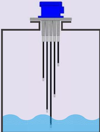
탱크 내부 수위가 낮아지게 되면 수위 센서에 설정된 Low 지점에서 DEC-5U-2WN의 Low 램프(Lamp)가 점등 되면서 Low 접점신호가 연결된 밸브(Vavle), 펌프(Pump), 경보(Alarm) 등을 구동하게 됩니다.
