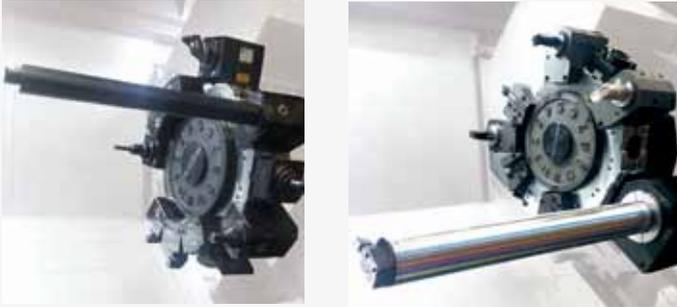
롱 보링바를 사용하여 깊은 내경 가공이 가능하여 가공 시간을 단축시켜 줍니다.
