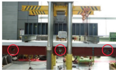
▲ 설비 구멍이 있는 BESTOBEAM 휨테스트
