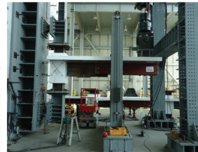
6. 기둥-보 접합부 내진성능 실험 Connection Seismic Test
