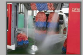
고압 예비세척 시스템 특수고압으로 차체에 묻은 이물질들 예비 세척 하여 세차시 흠집발생 방지
