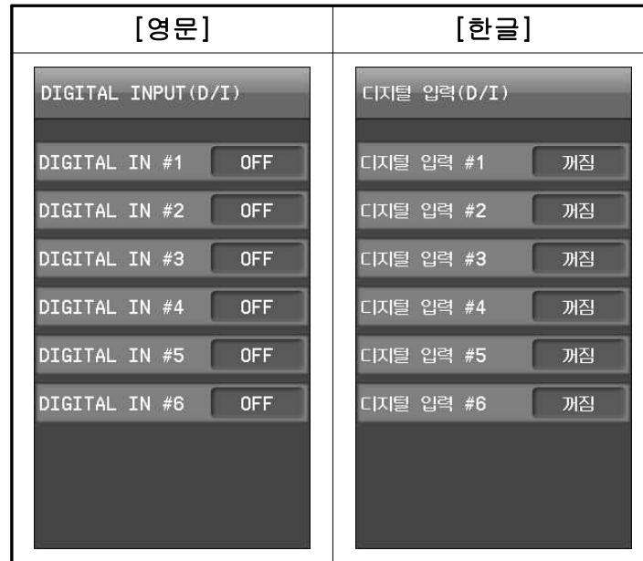
<Figure. DIGITAL INPUT(D/I) 상태 화면>
