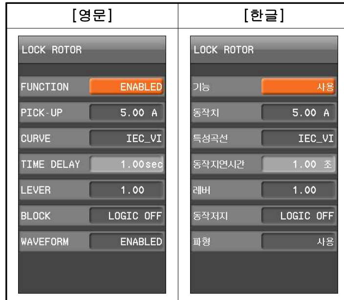
&lt;Figure. 회전자 구속 LOCK 보호(LOCK ROTOR) 설정 화면&gt;
