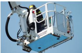
케이지는 최대 350KG 까지 수용할 수 있고 효율성과 내구성을 고려해 제작 되었으며 2 개의 출입문을 통해 신속한 출입이 가능합니다. 또한 케이지는 중앙으로부터 좌우 각각 40도 회전이 가능하며 케이지 수평 밸런스 시스템은 유압과 기계적 방식이 조합된 형태로 오류 위험성을 줄였습니다.
