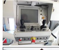
주조작반이 LCD 터치스크린으로 구성되어 조작자가 쉽고 빠른 조작이 가능합니다. 스크린에서는 장비의 현재 상태와 데이터들이 제공이 되어 주요 정보를 바탕으로 조작자가 보다 정확하고 정밀한 조작을 할 수 있습니다.
