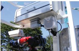
방수포는 사다리 상단에 설치되어 있으며 텐테이블 주조작반 또는 리모콘으로 편리하게 조작이 가능합니다. 또한, 방수포 위에 카메라가 장착되어 있으며 텐테이블 주조작반으로 화면이 실시간으로 전송되어 화재진압 시 정확한 조준이 가능하고 인명구조원들이 신속한 상황 판단 및 구조활동에 도움을 줍니다.
