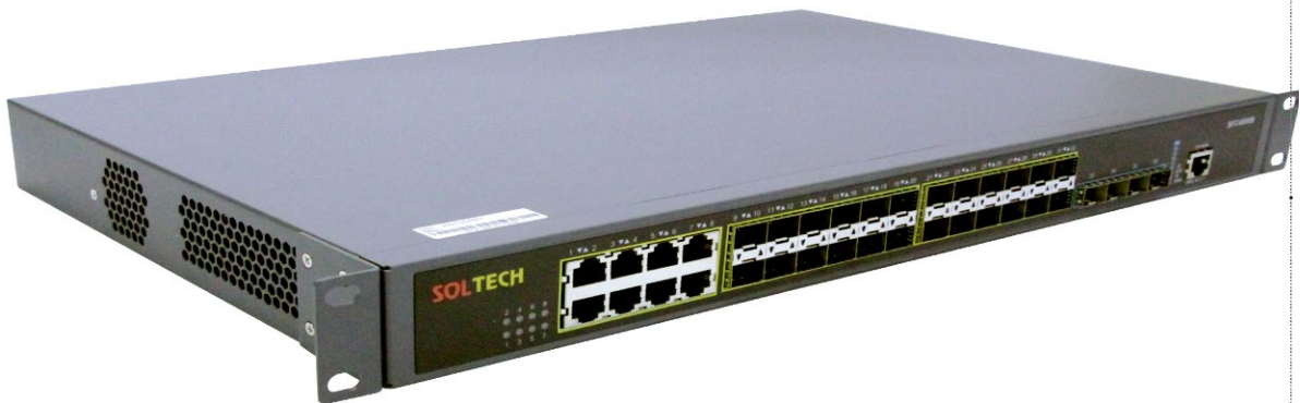
브라켓 장착 후 장비 (예시)
