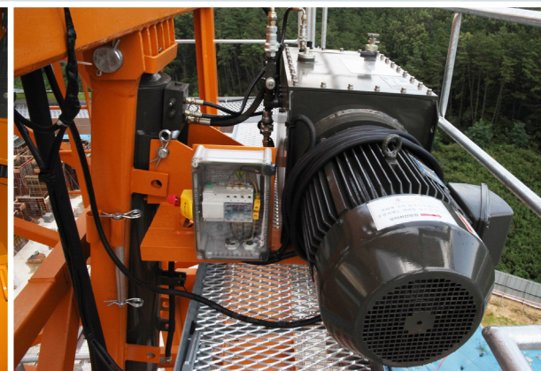
신뢰성 있는 부품을 적용한 클라이밍 유압 구동 시스템
