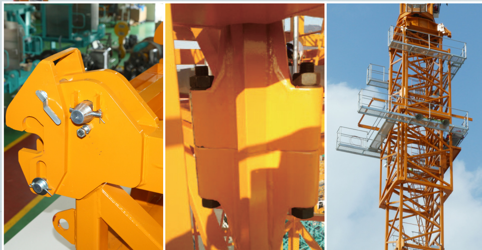
퀵커넥터 적용 설계를 통한 설치 해체 시간 단축
