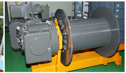
LEBUS DRUM 적용으로 안전성 확보 및 와이어 수명 증대
