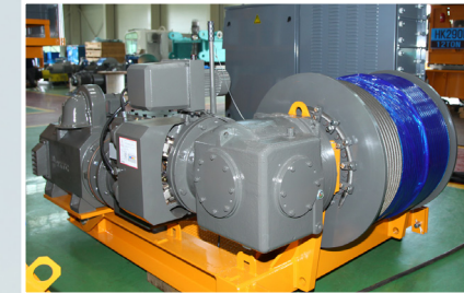
호이스트 윈치 일체형 구조로 설치 및 운송 편의성 증대
