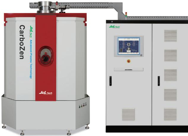
CARBOZEN™-H(Hybrid PVD)는 Linear Ion Source, UBM Sputter의 조합을 통하여 고객의 다양한 요구를 만족시키는 코팅 장비입니다.
