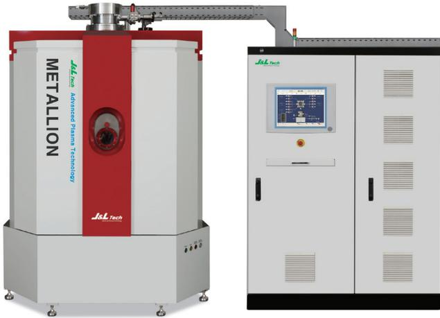
METALLION™은 아크 방전을 이용하여 음극부의 Metallic 타겟을 증발시켜 이를 표면에 증착 시키는 표면 코팅 장비입니다. 아크 방전은 저전압, 고전류의 방전 형태로 수십 V 이내의 전압에서 수백 A의 전류를 발생시키므로, 95% 이상의 높은 이온화를 달성하며 높은 증착률과 고경도 등의 특징을 보입니다. 이와 같은 내구성 코팅을 통해 다이캐스팅이나 고속 절삭 공구의 수명을 대폭 향상시킵니다.
