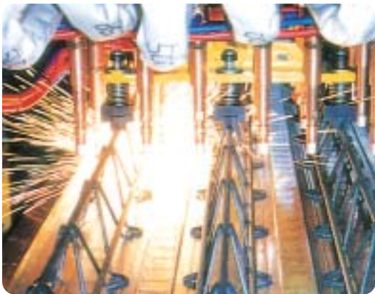
4 트러스거더 + 강판용접 (전기저항 용접)
