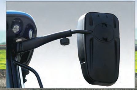
와이드 사이드 미러 캐빈내에서 위치 조정 가능한 전동식 및 열선 탑재로 깨끗한 시야확보를 제공합니다.
