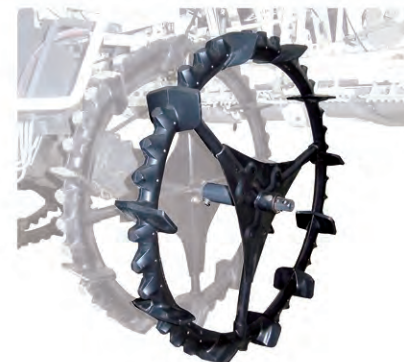
보조바퀴(외륜) 장착 (선택사양) 접지압을 낮추고 견인력을 증대시켜 어떠한 논작업에서도 강력한 이동성을 확보합니다.
