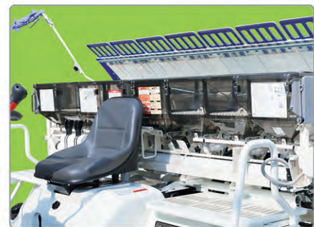
신형 립상 축조시비기 (선택사양) 13 L/조의 대용량 호퍼와 11cm 저중심 호퍼 채움으로 비료 보급횟수가 감소하여 작업 능률이 향상됩니다.
