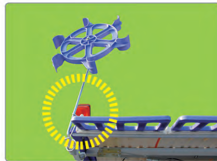
비료 떨어짐 알람 램프 비료가 적게되면 좌우 원커가 점멸하여 멀리 떨어져 있는 보조작업자에게 비료떨어짐을 알려 보급작업의 효율을 좋게 합니다.
