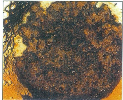
미방식으로 부식된 콘덴서 튜브 Corroded Condenser Tubes from Unprotecting
