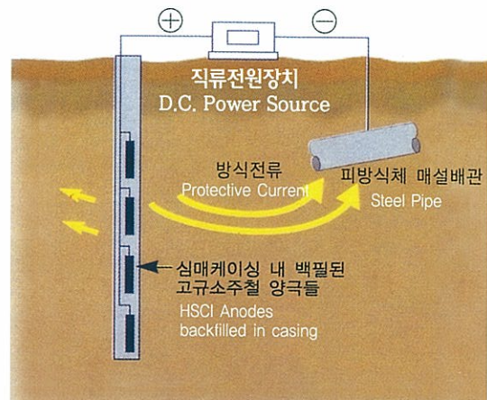
그림2. 심매용 고규소주철양극 FIG 2. H.S.C.I-ANODE for Deep Anode Bed Method
