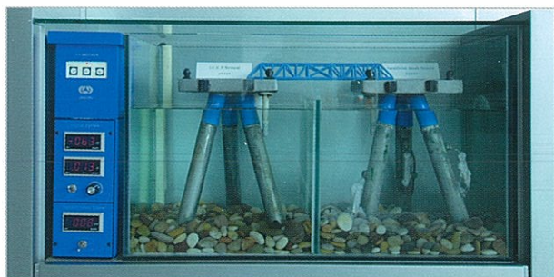
전기방식 시험조 / Simulation for Cathodic Protection
