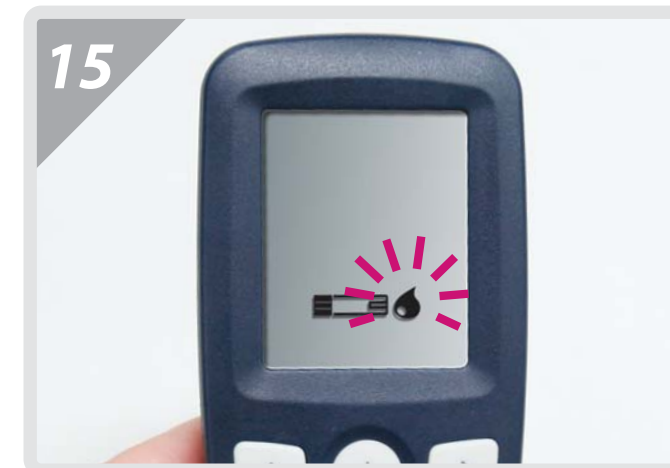
15 화면에 혈액 방울이 깜빡이는지 확인해 주세요. ※깜빡이지 않으면 시험지를 다시 끼워 주세요.
